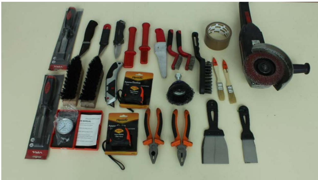
Рис. 2.3 – Набор инструмента для работы с конвейерной лентой: ножи различной формы, пассатижи (2 шт.), стамески (2 шт.), щетки-щетki (2 шт.), рулетки, корд-щетki с металлическим ворсом крупного, мелкого и среднего размера, кисти, шпатели, клейкая лента, шлифовальная машина с зачистным диском, твердомер
