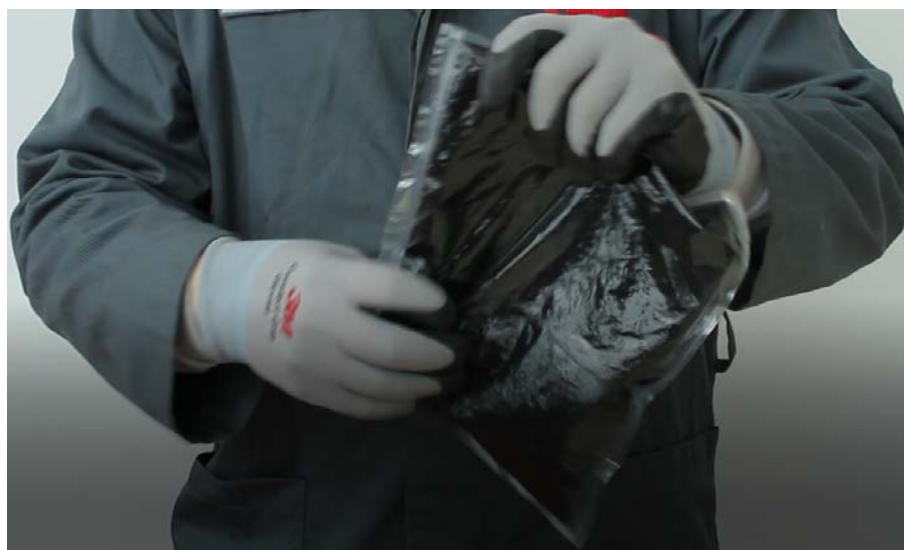
Рис. 2.16.1 – Выдавливание остатков пре-смолы и отвердителя из уголков пакета
