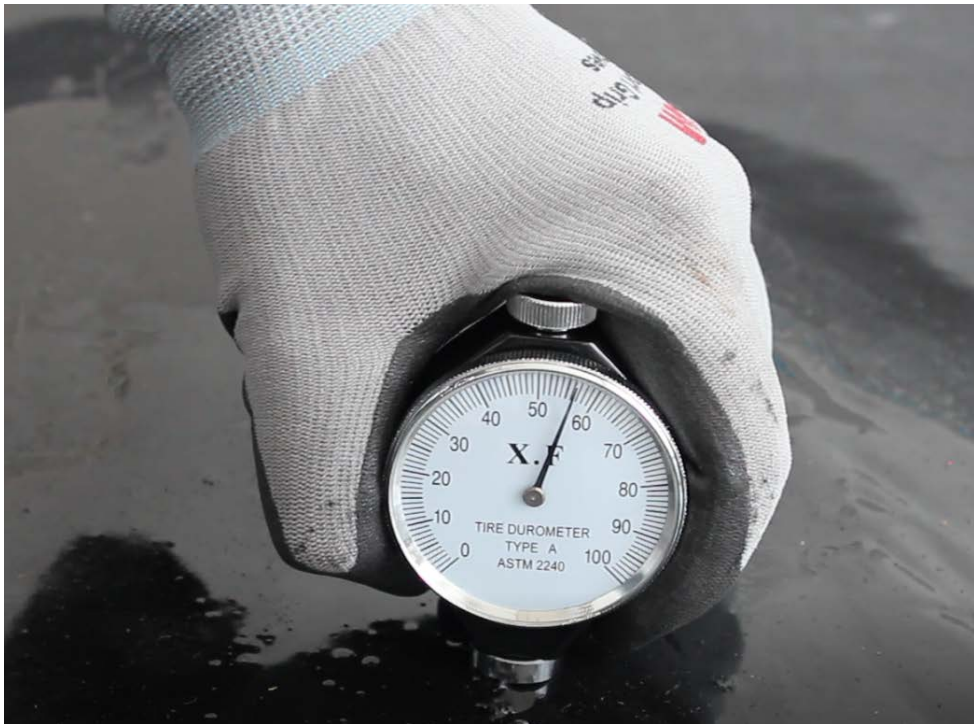
Рис. 2.24 – Измерение твердости материала по Шору (шкала А)
