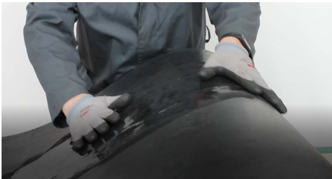
Рис. 2.25 – Готовый к работе отремонтированный участок конвейерной ленты
