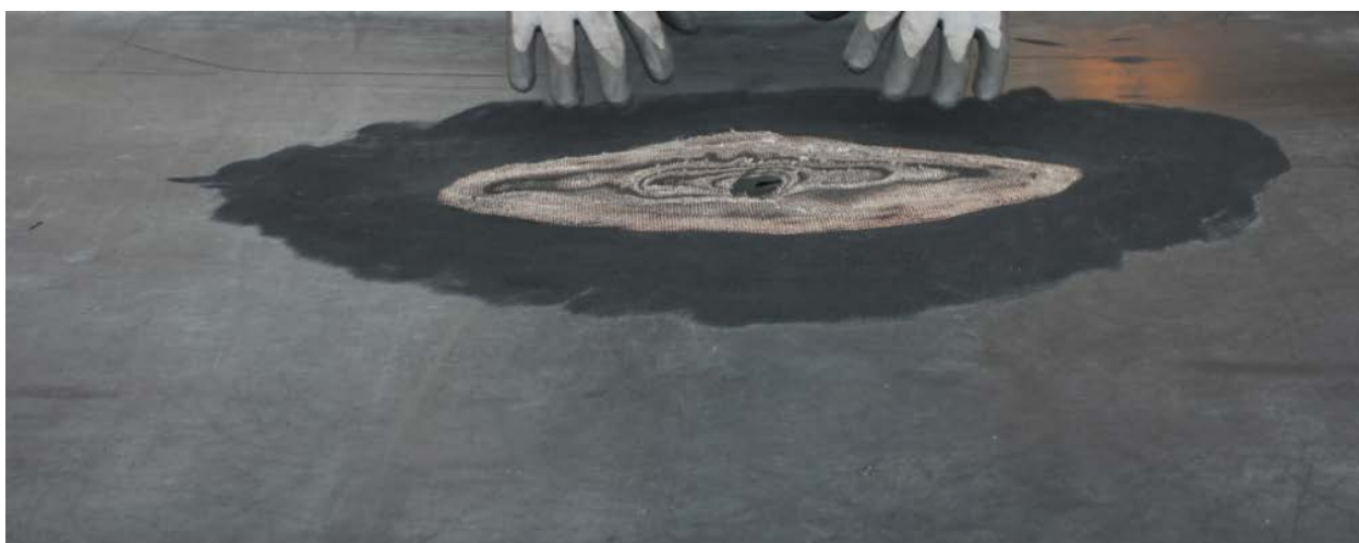
Рис. 2.4 – Поврежденная конвейерная лента
