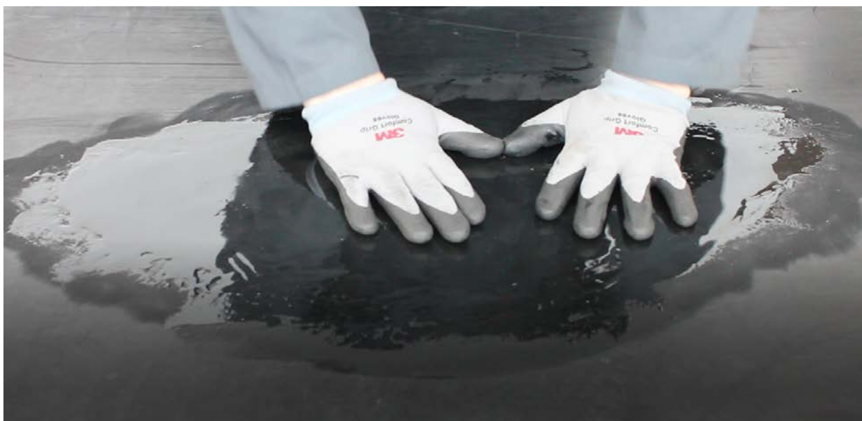
Рис. 2.23.1 – Проверка компаунда на липкость
