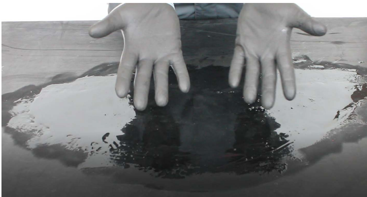
Рис. 2.23.2 – Результат проверки компаунда на липкость
